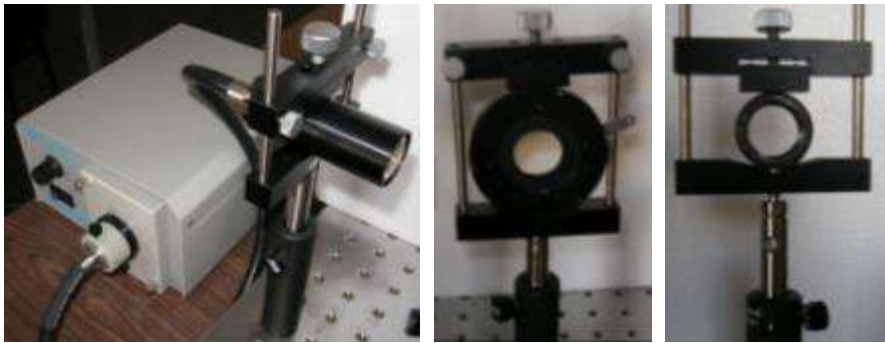
Fig. 3 Dispozitiv de iluminare, diafragma reglabilă și reticul
