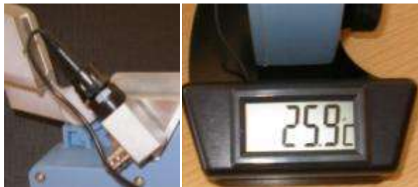
Fig. 6 Sonda de temperatură și indicarea acesteia
