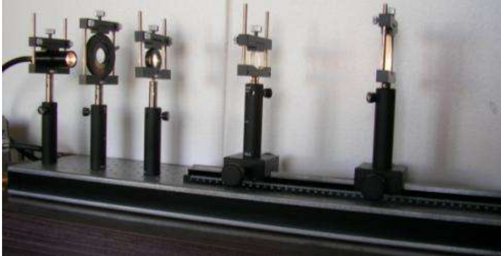
Fig. 2 Imagine de ansamblu al bancului optic configurat pentru măsurarea distanței focale
