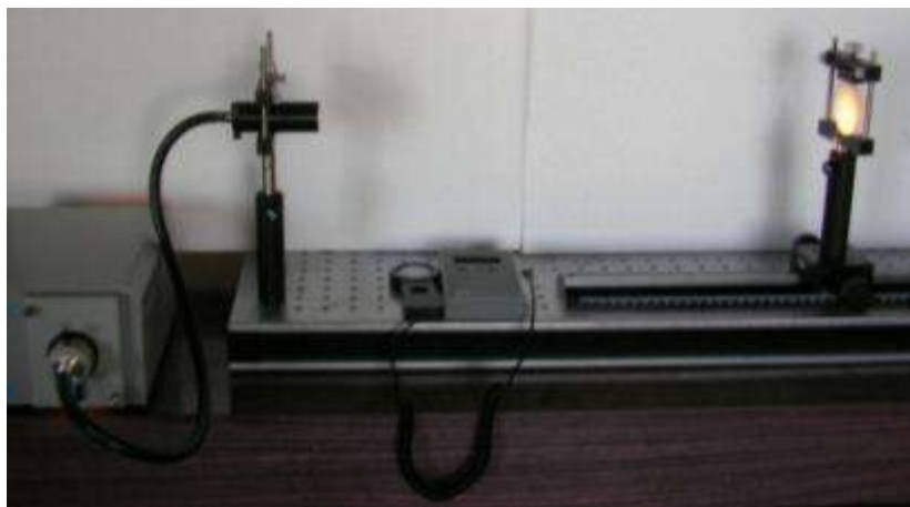
Fig. 2 Banc fotometric conținând sursa de măsurat, ecranul cu deplasare măsurabilă și luxmetrul
