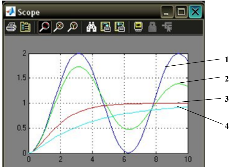
Fig. 3.45 Răspunsul sistemului de ordinul 2 la un semnal treaptă unitară (1- \xi = 0 ; 2- \xi = 0.1 ; 3- \xi = 1 ; 4- \xi = 2 ; \omega=1 )
