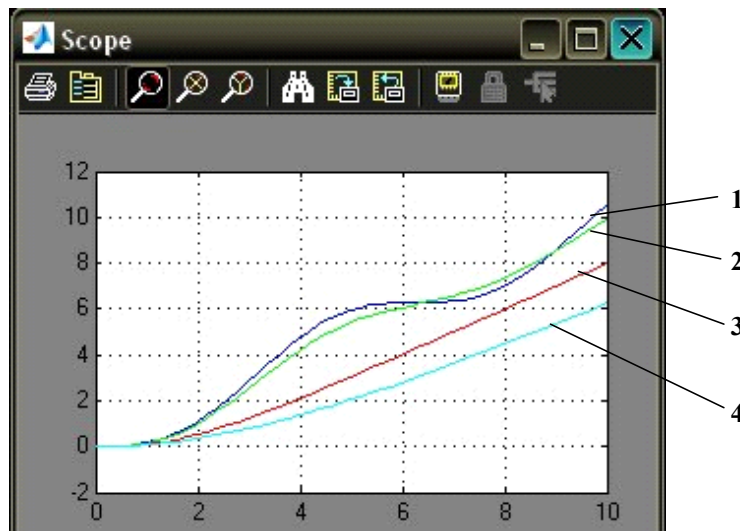
Fig. 3.46 Răspunsul sistemului de ordinul 2 la un semnal rampă unitară (1- \xi = 0 ; 2- \xi = 0.1 ; 3- \xi = 1 ; 4- \xi = 2 ; \omega=1 )
