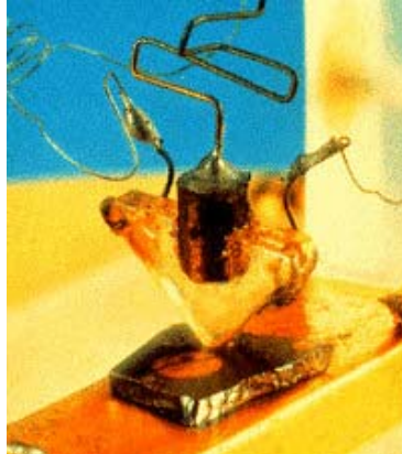
Fig. 1.15 Realizarea joncțiunii p-n
