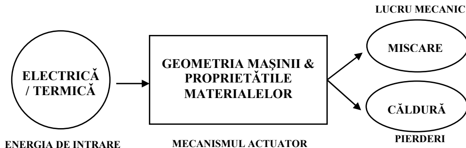
Fig. 7.107 Reprezentarea schematică a funcției unui actuator
