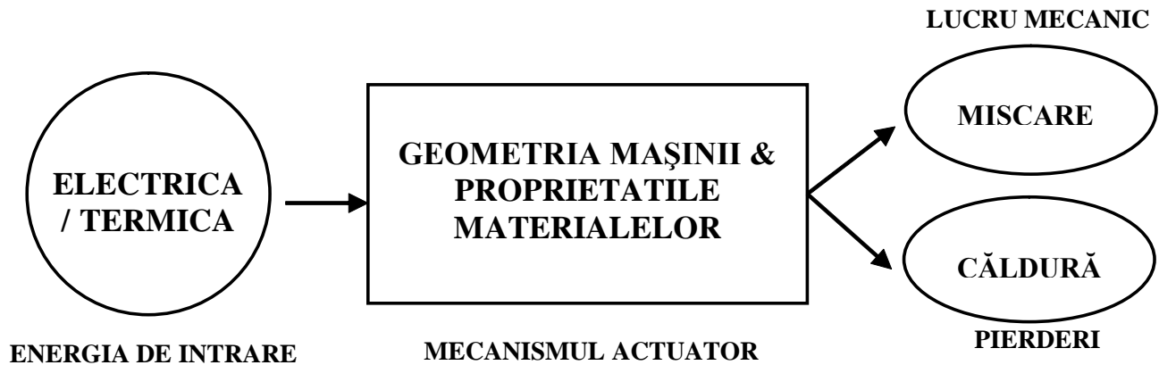
Fig.1 Reprezentarea schematică a funcției unui actuator
