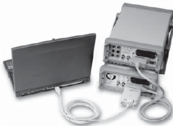
Fig. 3.37 Conectarea multiplă a unor instrumente de măsurare la PC prin interfața GPIB
