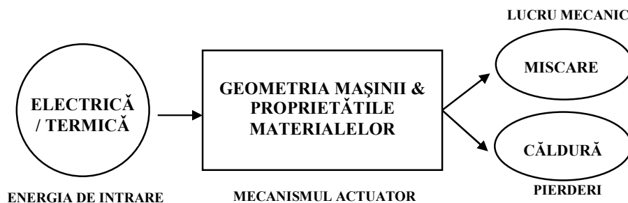
Fig. 1.1 Reprezentarea schematică a funcției unui actuator
