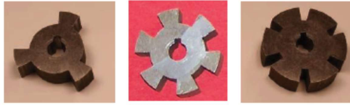
Fig.5 Imagini pentru formatorul de impulsuri
